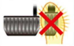
運転中にアクセルペダルとブレーキペダルを同時に踏み込んでしまった場合でも、アクセル信号を制御し、ブレーキ動作を優先します。その際ブレーキペダルだけを離してしまっても、アクセル信号を制御し、急発進を防止します\*\*。
